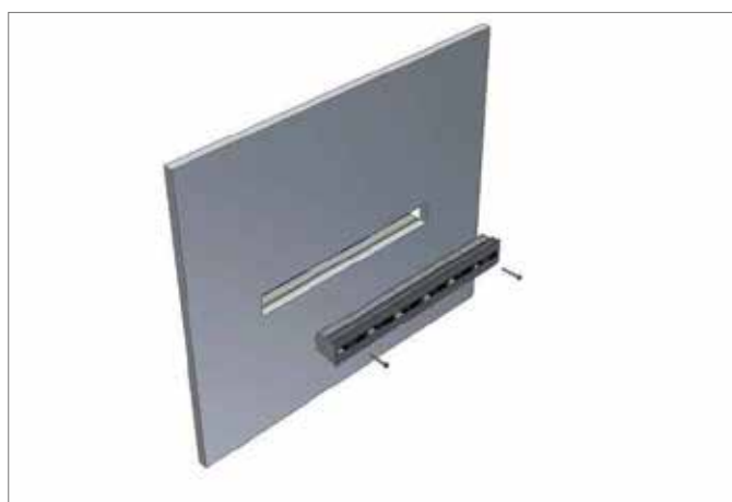
Inserire la bocchetta lineare e fissarla al plenum con le apposite viti
